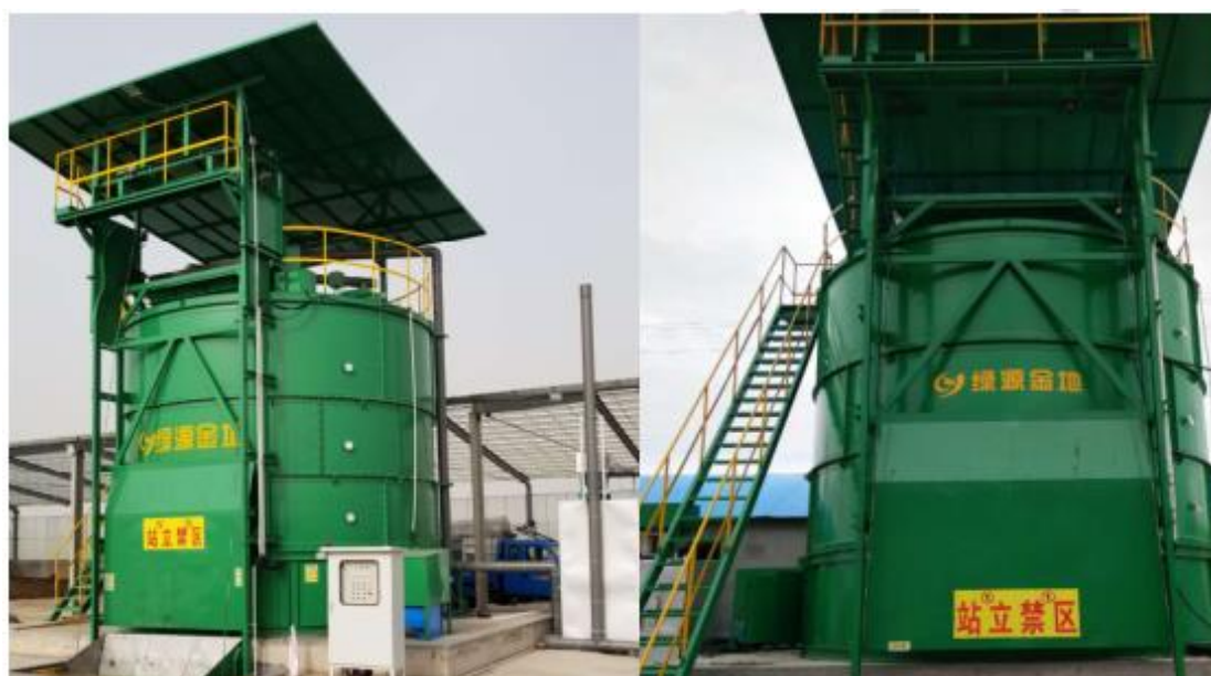
图 3.1-3 智能高温好氧发酵设备实体照片
